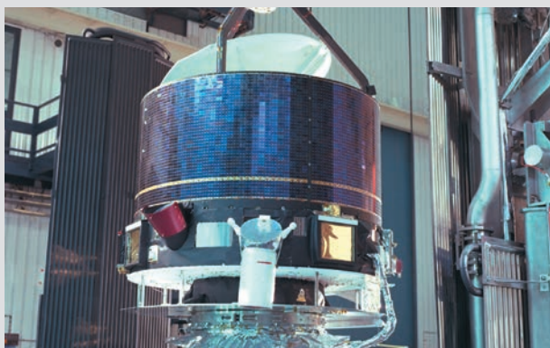
La nave Giotto lista para la prueba de simulación solar.
