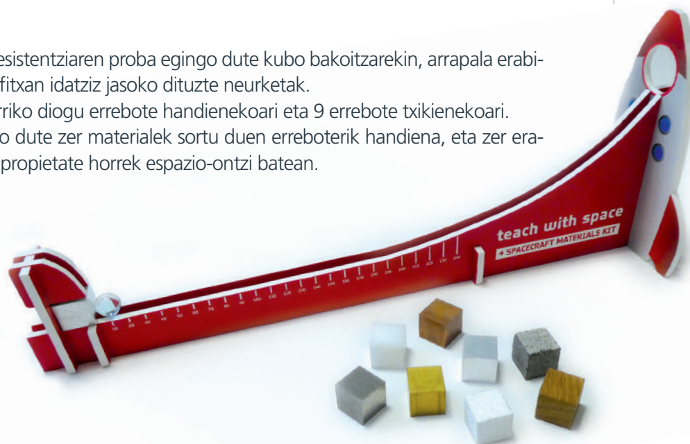
Inpaktuekiko erresistentziaren probarako muntaia
