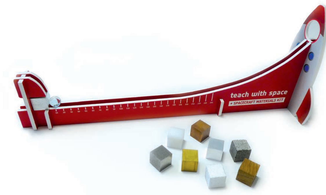
Rampla para comprobar a resistencia a impactos.
