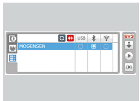
Cuadro de conexión del LEGO Mindstorm EV3.
