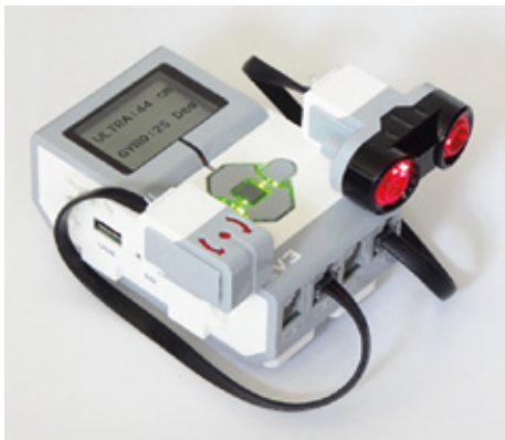
Sensor ultrasónico conectado al bloque EV3 de LEGO.
